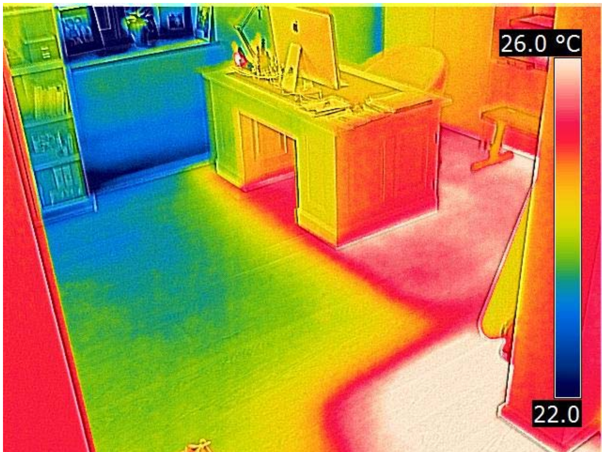
Abb.: 18.: Mangelhafte Regelung führt zu unterschiedlichen Temperaturniveaus innerhalb eines Raumes.
