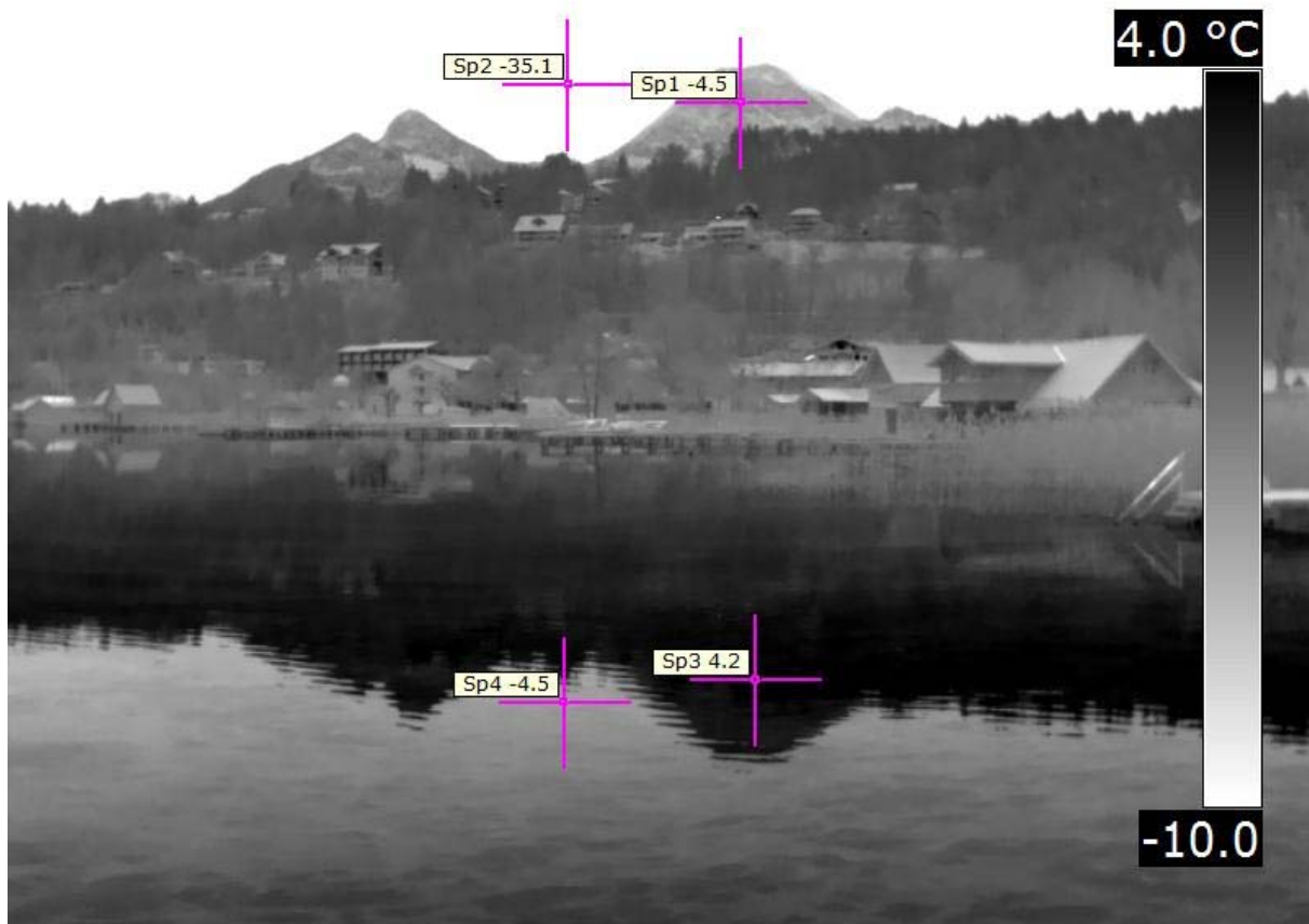
Abb.: 11.: Wasser hat einen sehr hohen Emissionskoeffizienten ( \epsilon \sim 0,95 ). Durch den flachen Winkel ist der Lambert Effekt – und damit die Spiegelung - deutlich erkennbar.
